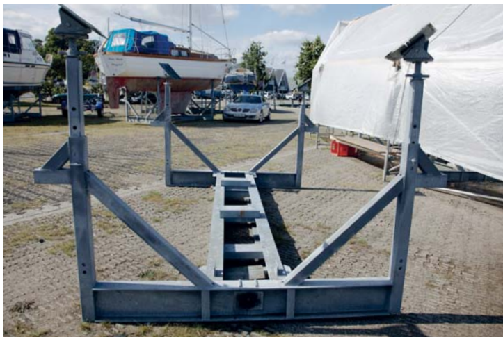
Dette solide universalstativ bliver standard på flere og flere havne. Det har den fordel, at det kan stables effektivt.
