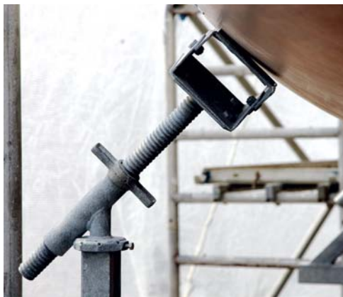
Der findes særlige støttepunkter til havnens nye standardstativer, så de også kan benyttes af mindre både som her.
