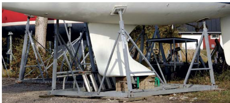
Denne båd står fint i et udmærket stativ, og den bliver støttet rigtigt, men klodslaget under kølen er principielt for højt.
