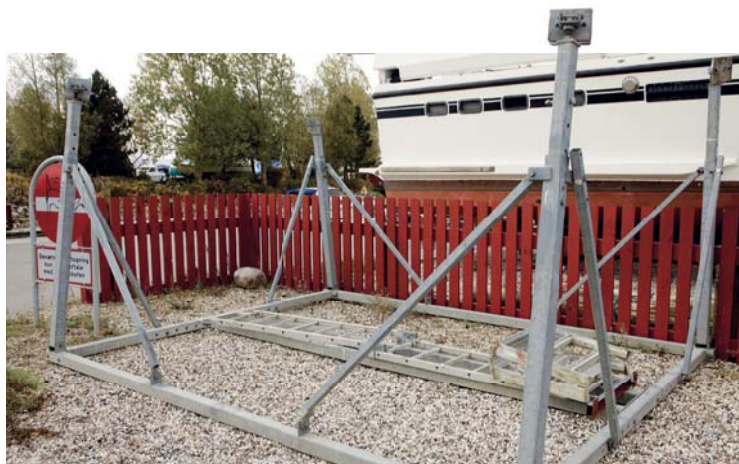
Her er et eksempel på et godt traditionelt bådstativ, der kan foldes sammen. Støtterne kan justeres til båden og er godt afstivet både langs skibs og tværskibs.
