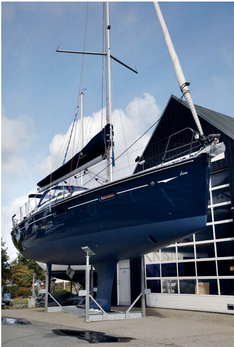
Det stiller ekstra krav til bådstativet, hvis man lader masten blive stående på båden, når den står på land. Her står båden i et solidt og forsvarligt stabelt stativ, der er standardstativ på flere havne.
