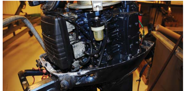
På motorens forkant ses tæreskader pga. for dårligt vedligehold.
