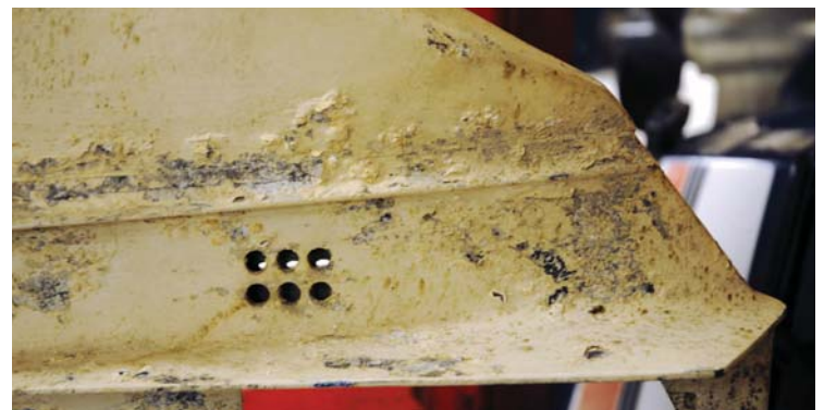
Denne motor har ikke fået udskiftet zinkanoden jævnlige.
