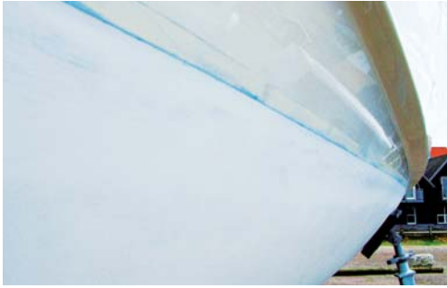
Indrømmet. Det er et stort arbejde at fjerne gammel bundmaling på en 30 år gammel glasfiberbåd.
