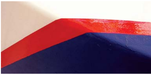
Bemærk at stafferingen skifter bredde for at synes ens i bredden, set direkte fra vandlinjen.
