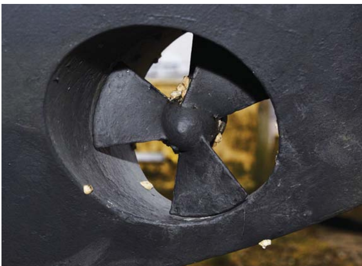
Det er især revnedannelse mellem skrog og tunnel, man skal være opmærksom på.
