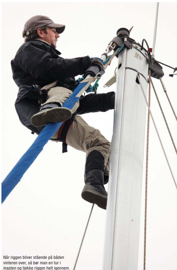
Tjek at sejlene ikke kan blive revet på salingshornenes endestykke.
