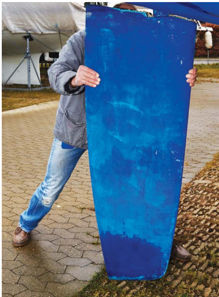
Et par hurtige rusk i rorbladet afslører straks slør i rorlejerne.
