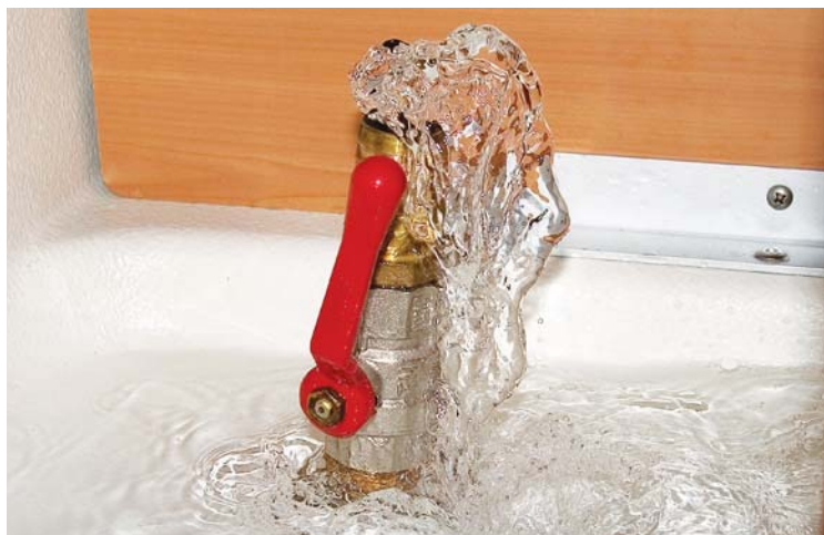
En defekt søventil er en af de hyppigste årsager til at både synker.
