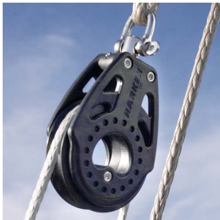
Blokke i hækstagnet, kick-halet og i fx spilergalgen skal være letløbende. Kuglelejblokke kan med fordel spules rene for snavs og salt.
