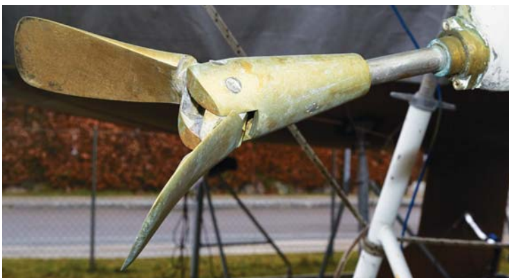
Tjek foldepropellen inden søsætning. En poleret propel fungerer bedst med mindst risiko for at blive begroet. Et tyndt fedtlag er også en mulighed.
