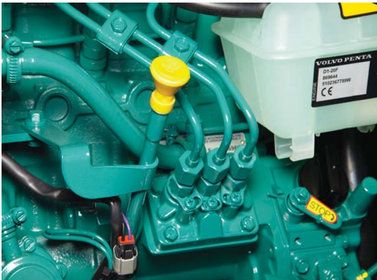
Olien skal skiftes inden første sejltur, hvis den ikke blev skiftet ved vinterkonserveringen.
