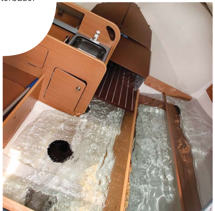
Det er især vigtigt at tjekke gennemføringer, søventiler, slanger og andre steder, hvor der hurtigt kan komme meget vand ind på kort tid, så man ikke risikerer, at båden synker som på billedet.
