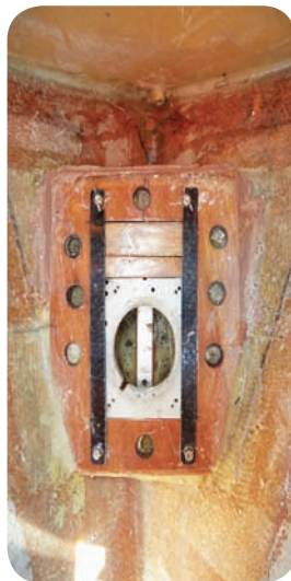
Det trimbare mastespor i bunden er specialbygget i mahogni-finer, til at passe ovenpå det indstøbte, aflange mastespor i jollen. De to skinner til at holde på trimklodserne er lavet af en kulfiber-sejlpind.
