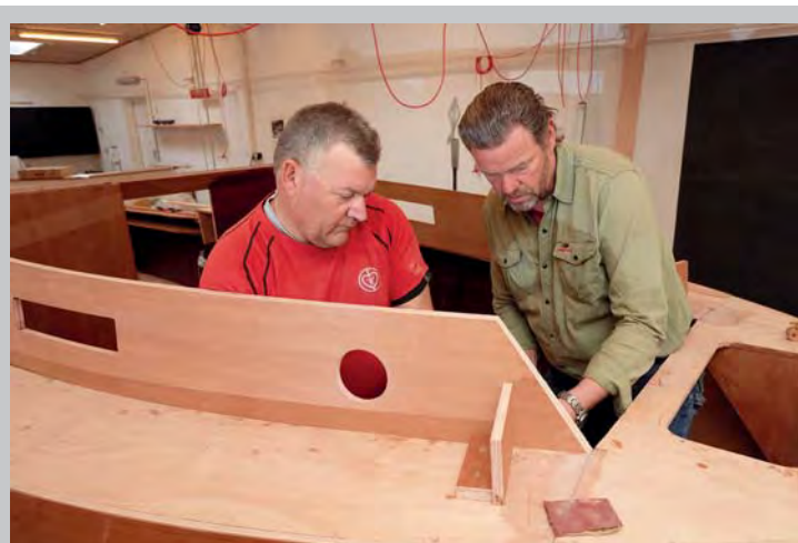
Søren Andersen og Per Mejer Rasmussen er her ved at montere den ene rufside i Honduras mahogni krydsfiner.
