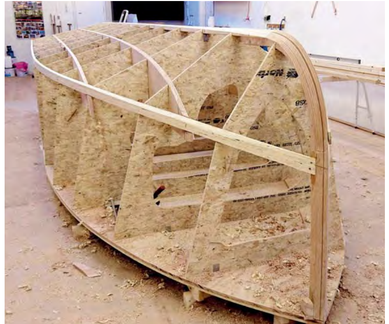
Formen er her klar til at gå i gang med at bygge båden. Bundstokken, stævnræret og bådens langskibs afstivninger i krydsfiner er monteret i formen af skabeloner i OSB plade.
