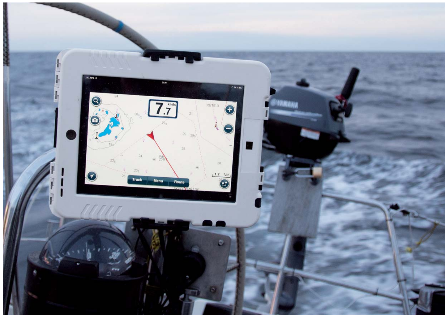
Vandtæt iPad med egen strømforsyning monteret på drejbart beslag. Her med Navionics' navigations-app.
