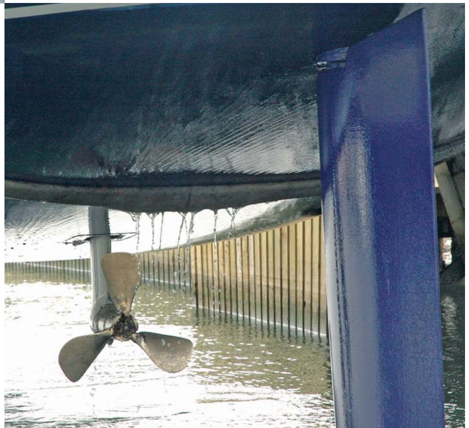
Skruens størrelse er et meget afgørende parameter. Hvilken skrue du kan montere afhænger af dit motorvalg.
