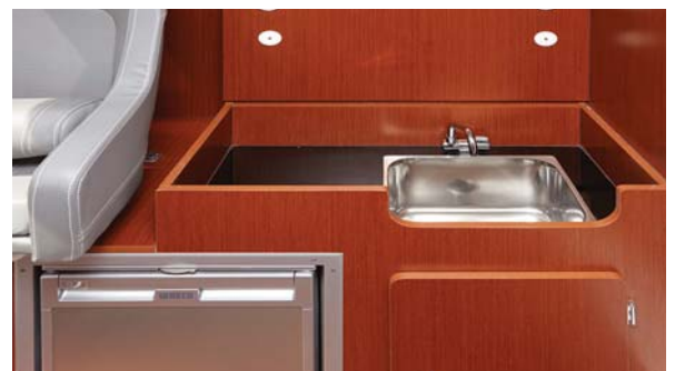
Under dobbeltsædet er der pantry med vask og trykvand i Elegance- og Nordic-versionerne samt et 42 liters køleskab. Der er ikke fast kogeplade.
