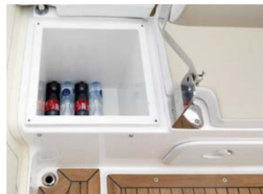
Der kan indbygges et elektrisk køleaggregat i denne køleboks. Under ryglænet er en vandtæt luger til et stuverum.
