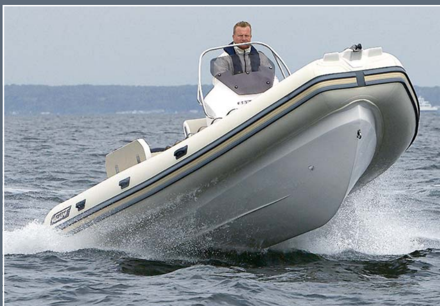
Vindspejlet er ikke stort, men afbøjer alligevel vindpresset så meget, at vores kasket ikke fløj af under testen. Bemærk, at der er et step på skroget, der er med til at stabilisere båden under planing.
