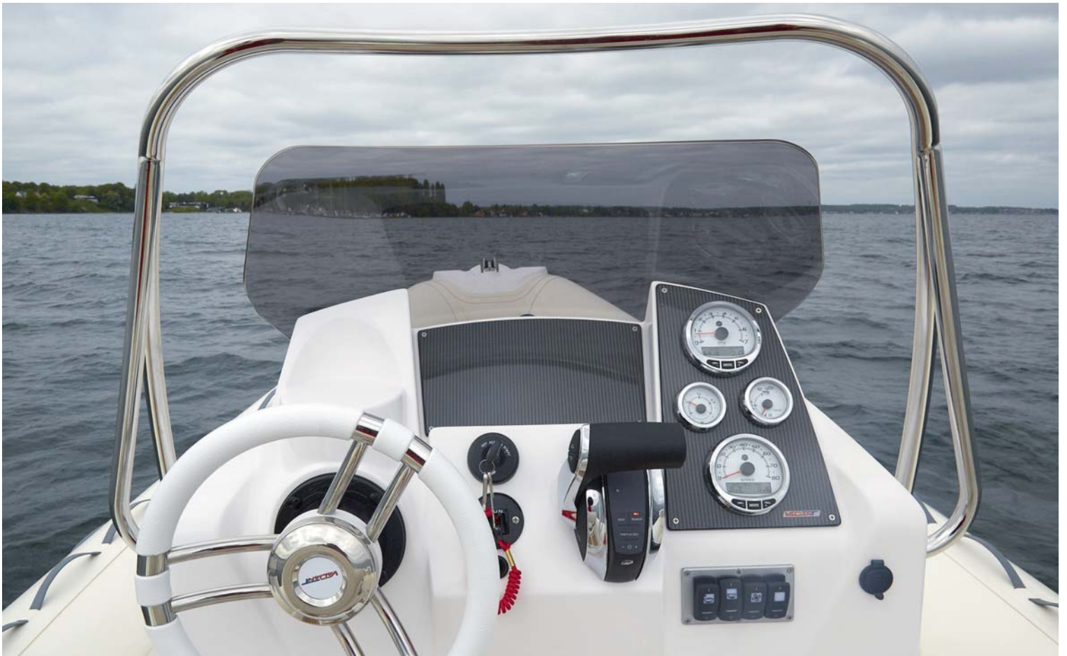
Styreconsollen er udmærket indrettet med godt overblik over instrumenterne. Der er plads til en mindre kortplotter. Motoren blev justeret med et elektronisk gas- og gearhåndtag, der ses i midten. Stålbøjlen på konsollen var fin at holde sig fast med.
